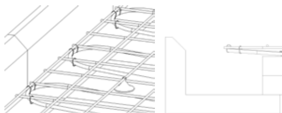
Bild 10a/b. Hamnar rören ovanför kantbalkens dal är buntband nödvändiga för att fixera golvvärmerören mot armeringsmattan.
